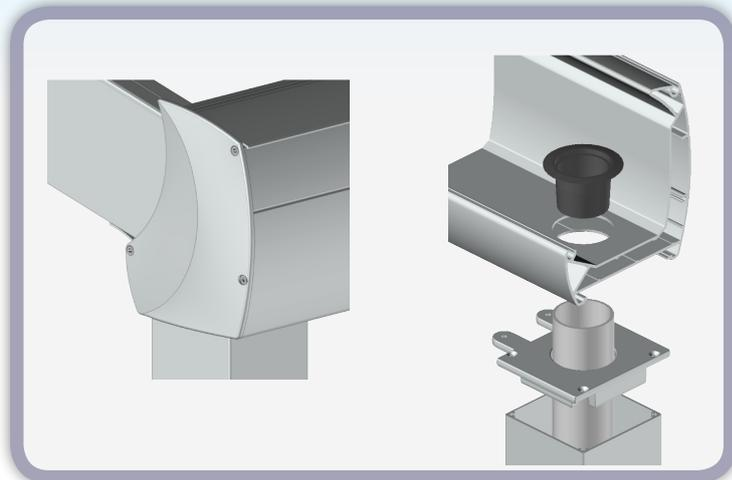
L'écoulement des eaux de pluie s'effectue par les tubes insérés dans les profils des poteaux. La couverture de la toiture en polycarbonate assure l'étanchéité à l'eau.
